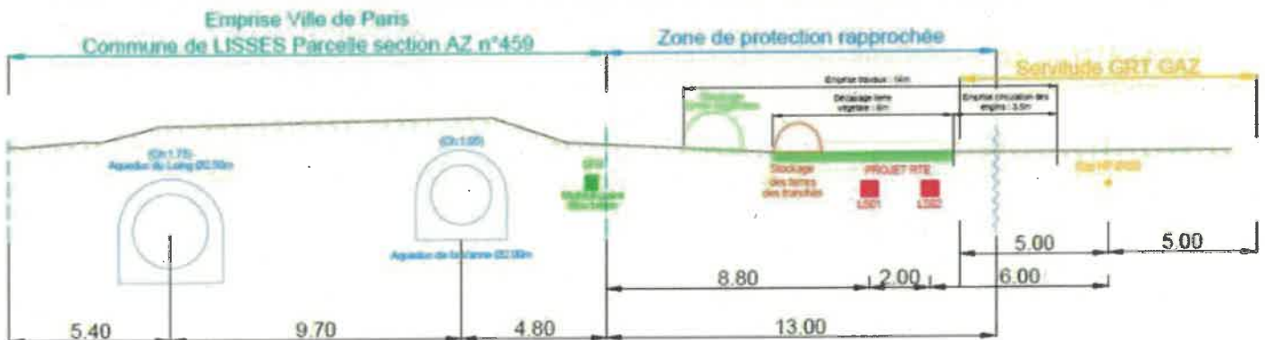
Figure 64 : Schéma de principe de la bande d'implantation sur le premier tronçon
